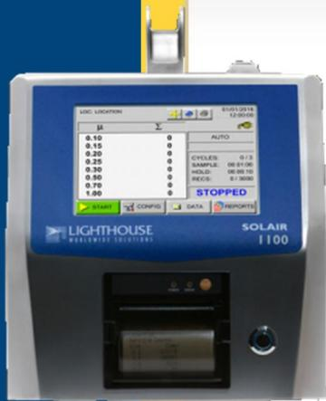
SOLAIR 1100LD 粒子计数器, 具有 0.1 微米感应度和 1 立方英尺/分钟 (28.3 升/分钟) 流速, 使用长寿命激光二极管技术。比常见的 HeNe 激光粒子计数器需要更少的日常维护 (不需要日常的激光管代替或者光学清洁和考虑其低浓度限制)。SOLAIR 1100LD 被设计用于 ISO 一级到七级洁净室操作, 无须担心减少空气或者是超过密度限制。
