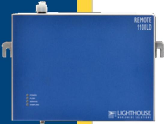
远程在线粒子传感器 Remote 1104 LD, 具有 0.1 微米感应度和 1 立方英尺/分钟 (28.3 升/分钟) 流速, 采用光学和光电二极管系统, 有效的降低或消除与高功率激光二极管传感器相关的温度问题。
